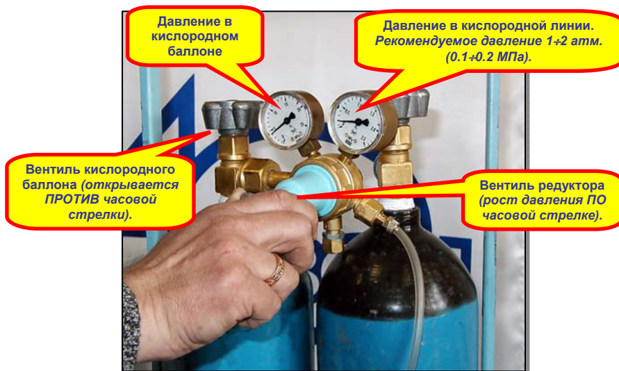
Рис.12. Регулировка давления в кислородной линии.
