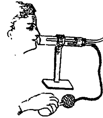
Рис. 3 Схема ингаляционного воздействия озонированным воздухом с использованием вакуумных электродов от аппарата для местной дарсонвализации.
