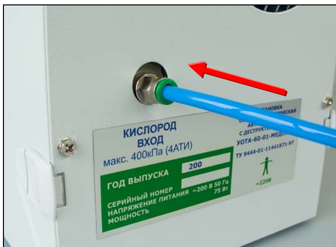
Рис.6. Подключение кислородной магистрали к установке УОТА-60-01.
