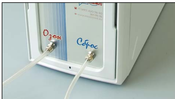
Рис.14. Подключение оснастки к установке УОТА-60-01.
