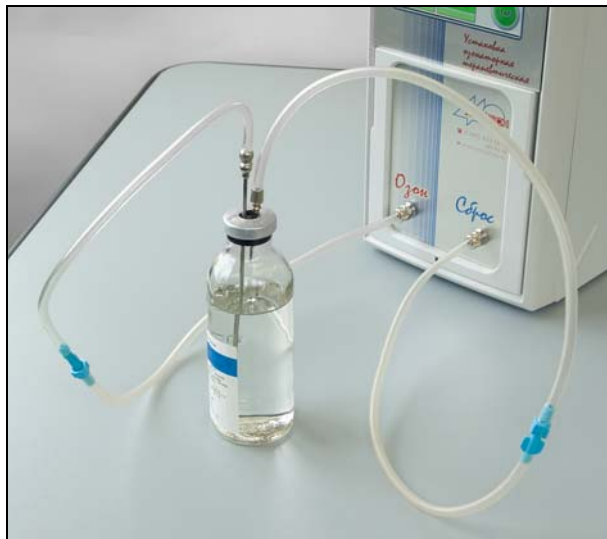
Рис.23. Ввод барботажных игл во флакон с физиологическим раствором.
